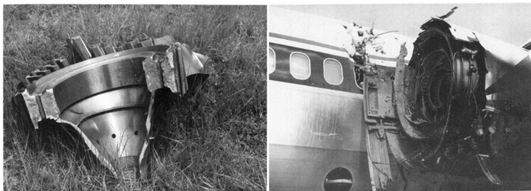
FIGURE 1 – Accident Pensacola, Floride, USA, 06 juillet 1996. Eclatement d'un disque de MD88 Delta Air Lines, Moteur P&W JT8D.
