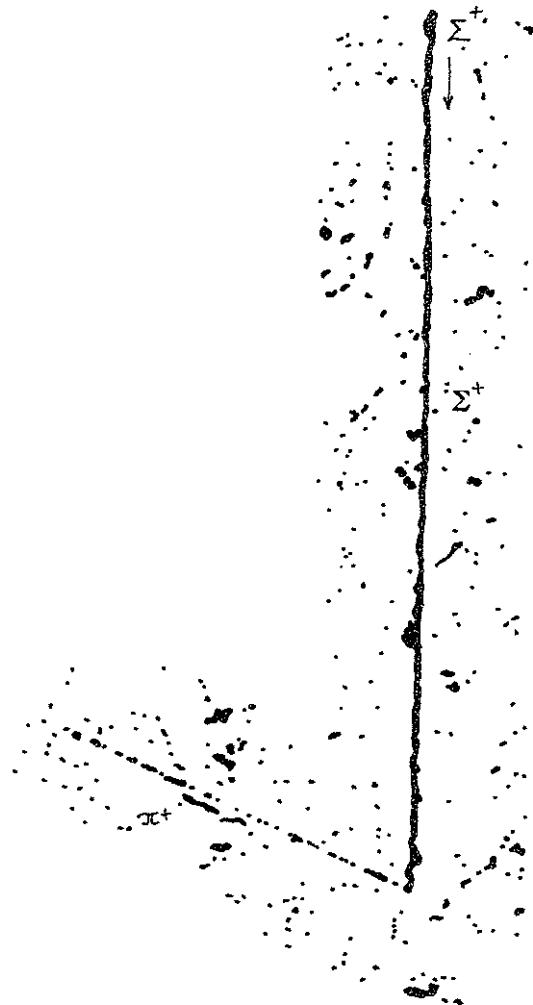
Fig. 18 Premier exemplaire d'un hypéron \Sigma^+ observé dans une émulsion photographique; il se désintègre en un pion positif et un neutron.
