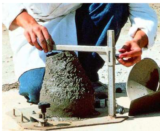
FIGURE 2 – Affaissement après avoir retiré le cône d'Abrams
